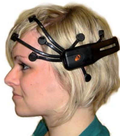
Snímání mozkové aktivity pomocí EEG umí změřit pozitivní a negativní emoční zaujetí.
