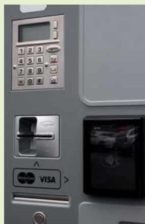
Součástí pokladny je čtečka kontaktních i bezkontaktních karet a PIN Pad s displejem pro zadávání PIN.
