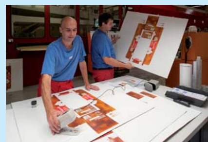
Kontrola prověřuje přesnost barevného soutisku prodejního obalu.
