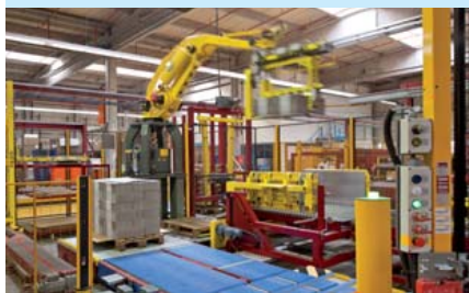
Manipulační robot za ochrannou síť nahrazuje lidskou sílu, která by nestačila dnešní provozní rychlosti.
