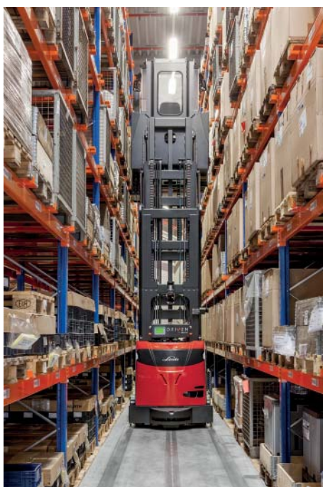
Robotický VNA vozík Linde K-MATIC se zdvihem až do 12 m.
