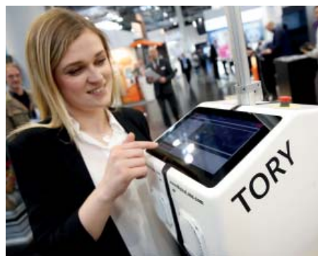
Společnost MetroLabs představila robota Toryho, který projíždí mezi regály a skenováním RFID tagů kontroluje prezenci zboží.
